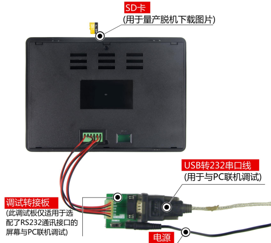
图 1-3 RS232 调试工具图
