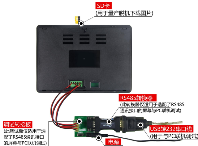
图 1-4 RS485 调试工具图
